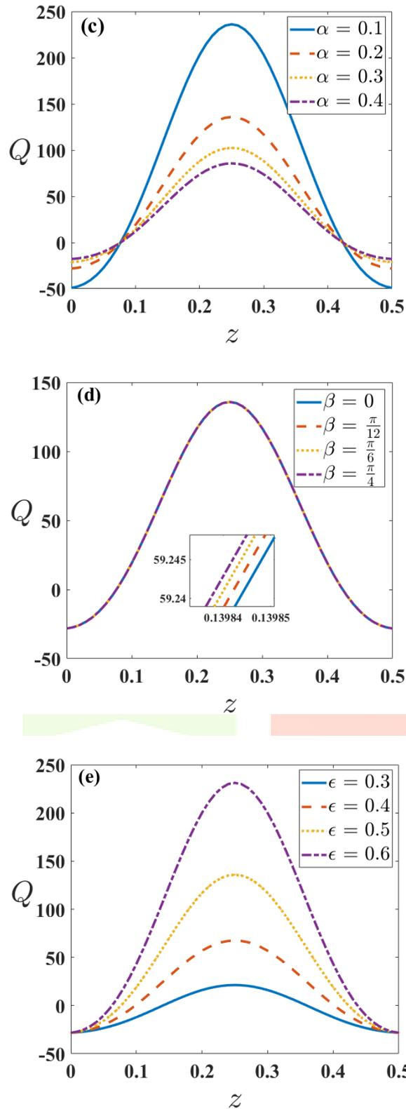
**Figure 2.  $Q$  versus  $z$  for varying (a) Jeffery parameter ( $\lambda_1$ ), (b) porous parameter ( $Da$ ), (c) velocity slip parameter ( $\alpha$ ), (d) angle of inclination ( $\beta$ ) and (e) amplitude ratio ( $\epsilon$ ).**
