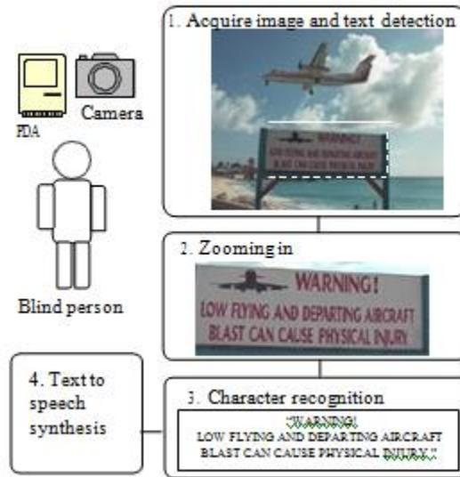
Figure1 System configuration (walk-around mode)
