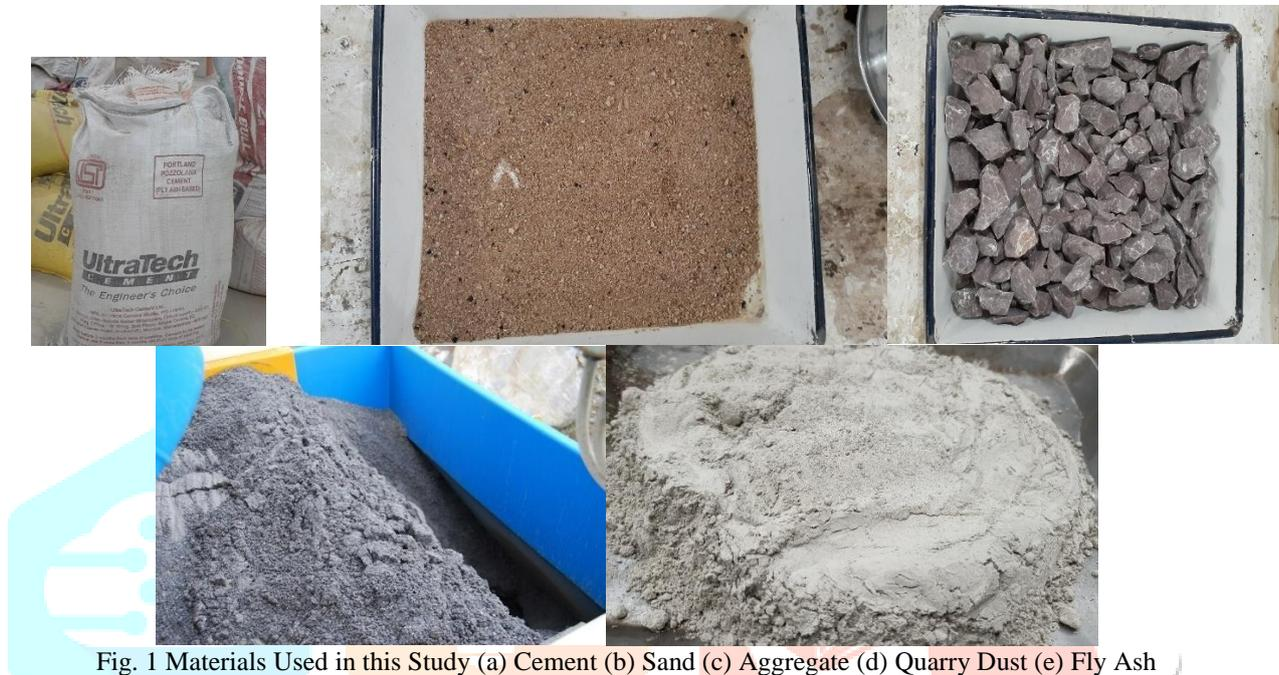
Fig. 1 Materials Used in this Study (a) Cement (b) Sand (c) Aggregate (d) Quarry Dust (e) Fly Ash
