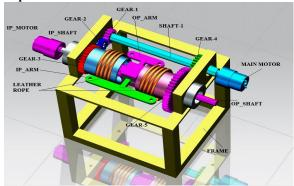
TEST & TRIAL ON POWER AMPLIFIER MATERIAL OF BAND: COTTON ROPE
